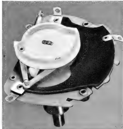
Bild 6. Das Abstimpmpotentiometer mit der Umschalt-Steuerscheibe
