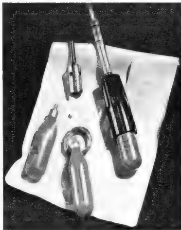
Der handliche LötKolben mit nur 19 cm Länge wird mit Butangas betrieben. Die links daneben liegende Lötspitze steckt man zum Gebrauch auf die Messinghülse des Mundstückes. Das Ventil der Gaspatrone läßt sich durch eine Vierteldrehung jederzeit abstellen
