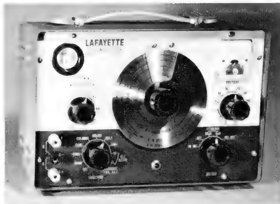
Bild 1. Frontansicht der Lafayette-Meßbrücke TE-46
